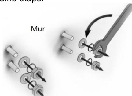
**Étape 3:** Fixer le support de fixation du radiateur sur les quatre boulons d'expansion.
